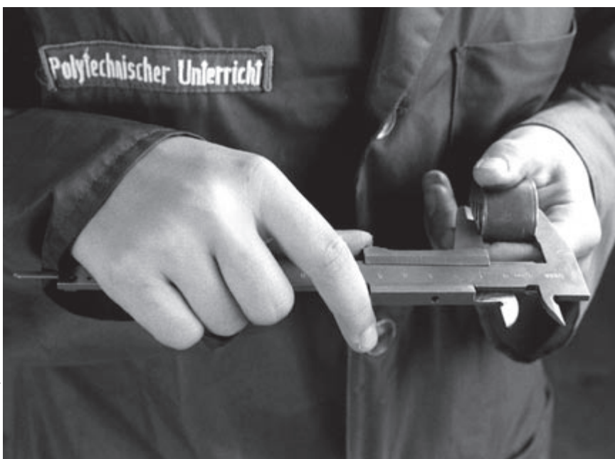
Ein Schüler einer Polytechnischen Oberschule aus Berlin (Ost) mit einer Schieblehre beim Messen eines Metallstücks im Polytechnischen Unterricht im UTP-Zentrum des VEB Fortschritt in Berlin. Mit einem regelmäßig in den Stundenplan eingebundenen »Unterrichtstag in der Produktion« (UTP) sollten die Schüler in der DDR an das Arbeitsleben in den volkseigenen Betrieben herangeführt werden.
